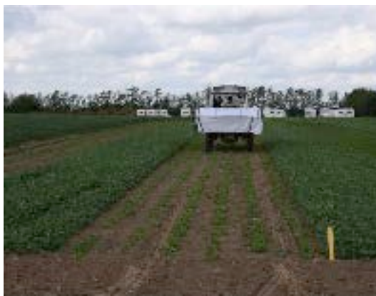
Figur 7: Traktor påmonteret SDU-kamera og GPS igang med at skanne en parcel med roer 2011.
